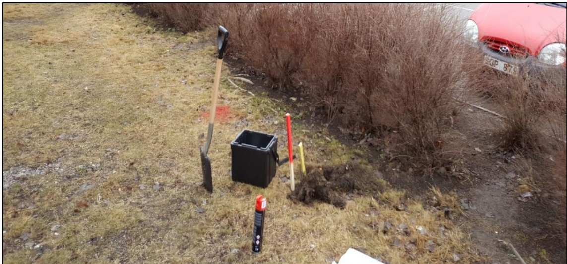
Figur 3. Provgropar grävdes med handspade ner till max 0,5 m.u.my. Källa: ÅF Infrastructure AB
