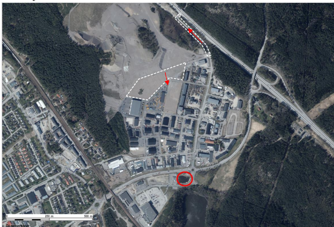
Figur 6. Planområdet markerat med vitstreckad linje. Föreslagna avrinningsvägar (röda pilar). Befintlig dagvattendamm vid Lillsjön markerad i rött.
